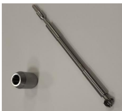
Figura 25 - Valve Rod com fragmentos após usinagem
