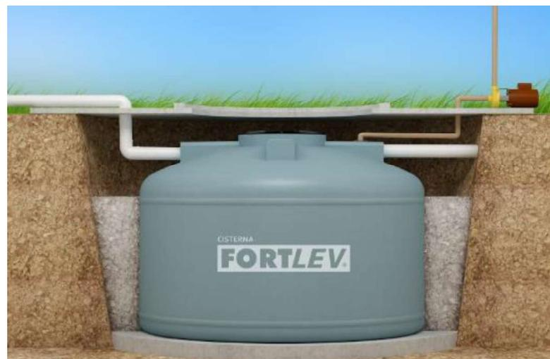
Figura 21: Ilustração de um reservatório enterrado.
