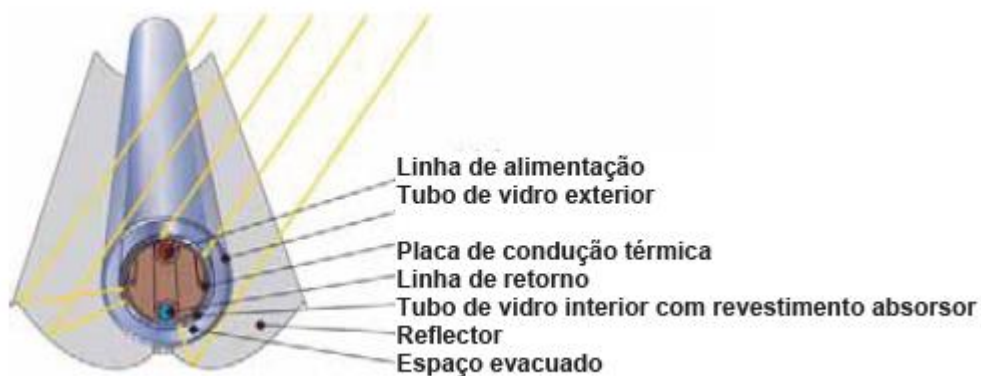
Figura 17: Perfil do coletor tubo à vácuo de fluxo direto Fonte: PORTAL ENERGIA (2004)
