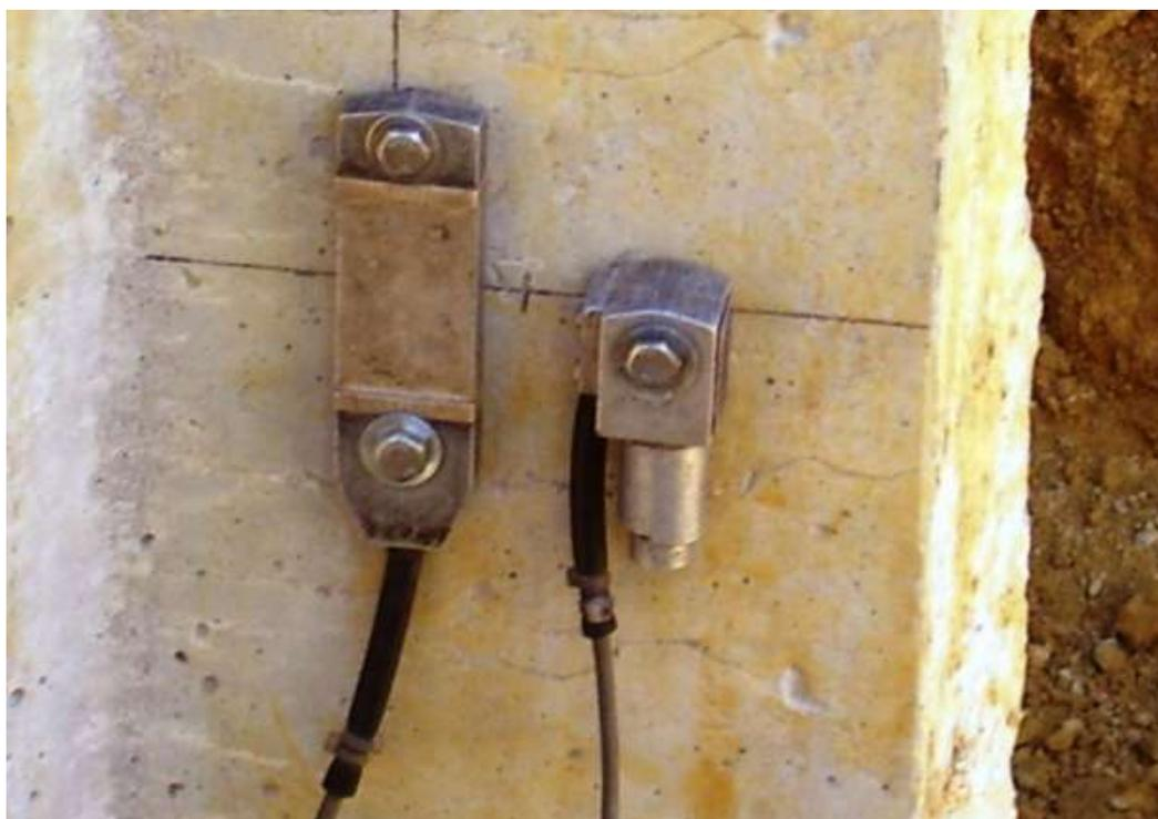
Figura 2.13: Sensores instalados na estaca para a realização do PCD, Marchezini (2013).
