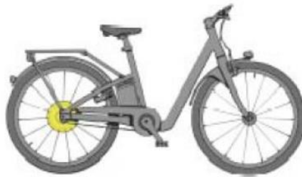
Figura 8 - Motor elétrico alojado direto no cubo. Fonte: GENERALWINGS.
