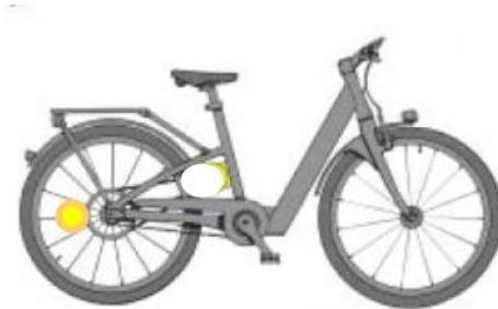
Figura 10 – Motor elétrico alojado na roda traseira Fonte: GENERALWINGS
