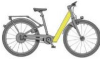
Figura 14- Bateria alojada no tubo inferior. Fonte: GENERALWINGS.
