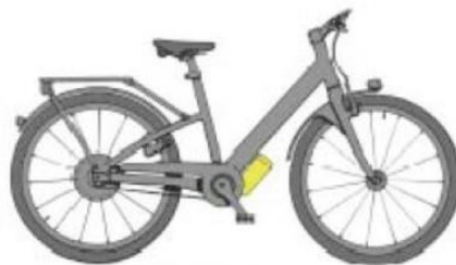
Figura 9 - Motor elétrico alojado direto no movimento central. Fonte: GENERALWINGS
