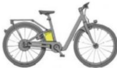
Figura 13 - Bateria alojada no quadro
