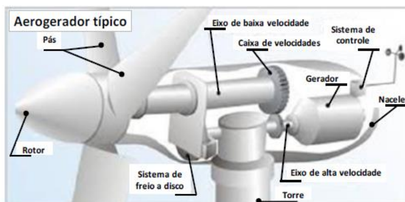
Figura 20 - Componentes de uma turbina eólica de eixo horizontal (Wikipedia).
