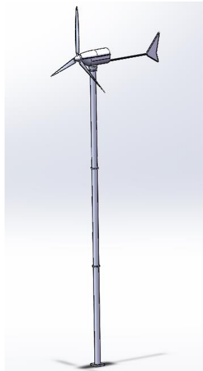
Figura 48 – Representação 3D do conjunto torre/turbina.
