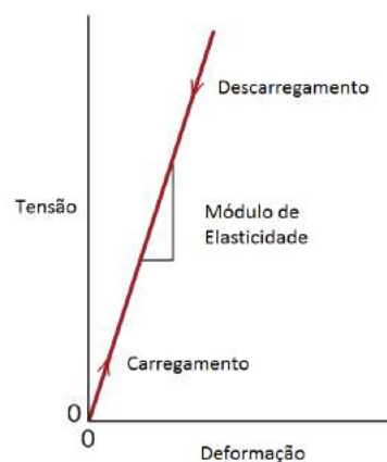
Figura 3.1 – Diagrama tensão-deformação mostrando deformação elástica linear. Fonte: Callister, 2007, traduzido do inglês
