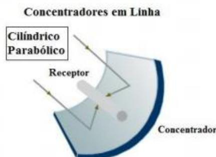
Figura 2: Funcionamento de cilindro – parabólico mediante incidência de radiação solar.
