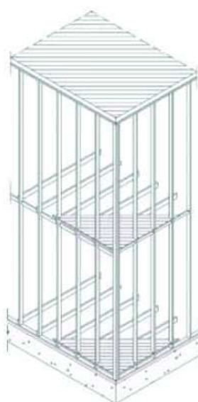
Figura 2.4 – Conceito de modulação e estrutura alinhada (Steel Framing: Arquitetura, 2012).
