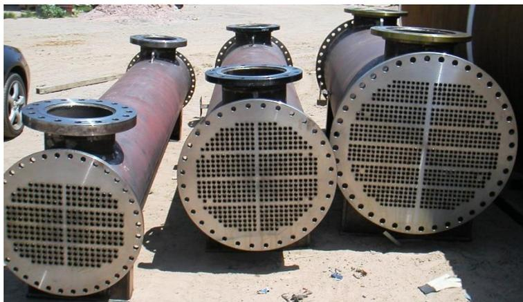
Figura 12 - Exemplo de trocador de calor do tipo casco-tubo.
