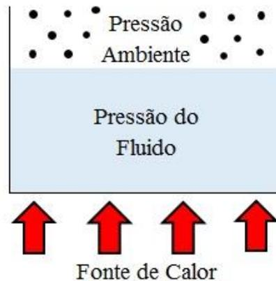
Figura 8 - Evaporação por ebulição.
