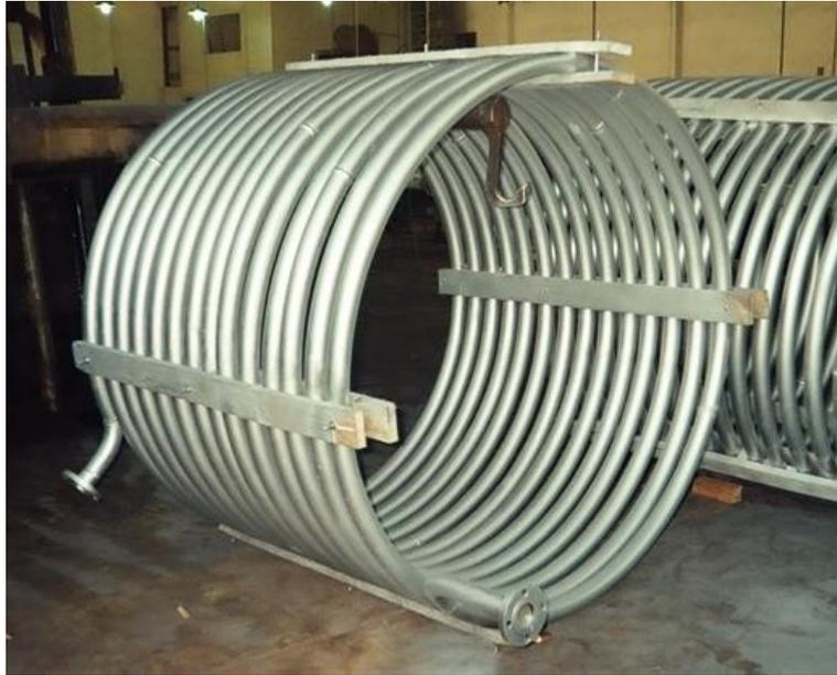
Figura 13 - Exemplo de trocador de calor do tipo casco-serpentina.
