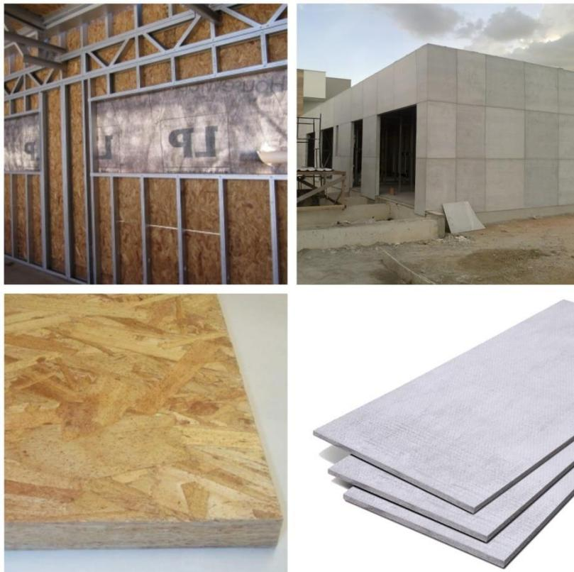
Figura 2.17 – Placas OSB e placas cimentícias. (SALLES, 2016)
