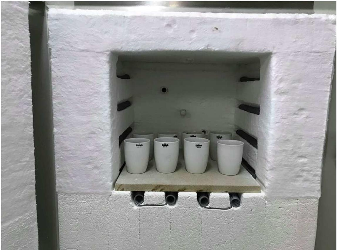
Fig 4.11 - Execução do ensaio de determinação do teor de orgânica – cadinhos organizados na mufla. Fonte: Autoria Própria.
