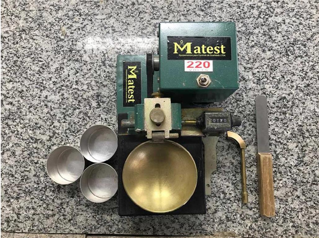
Fig. 2.2 - Aparelho de Casagrande utilizado no Laboratório de Mecânica dos Solos da UFRJ Campus Macaé – marca Matest. Fonte: Autoria Própria.
