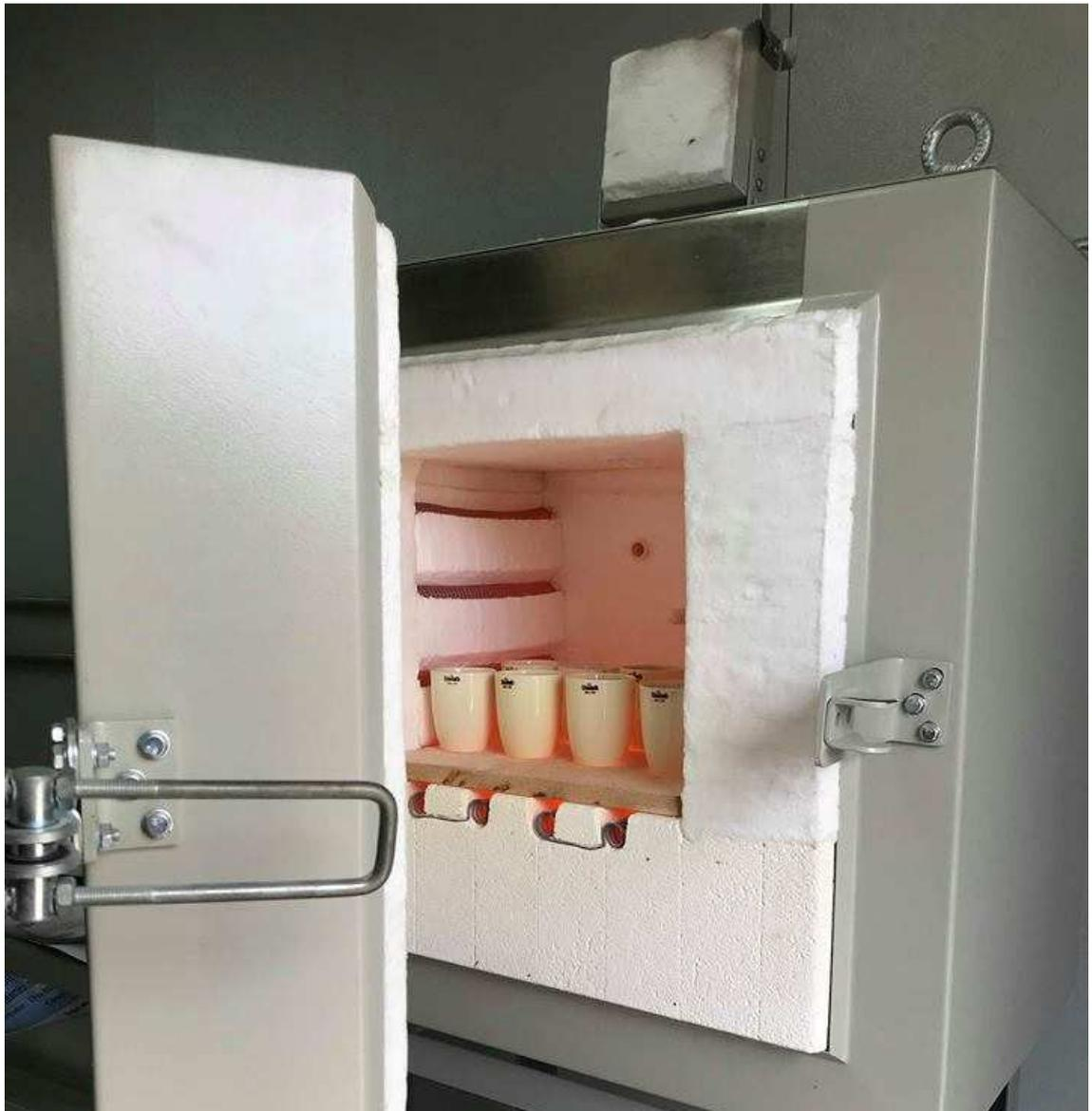
Fig. 4.12 - Execução do ensaio de determinação do teor de orgânica – retirada dos cadinhos da mufla após o tempo estabelecido na norma. Fonte: Autoria Própria.
