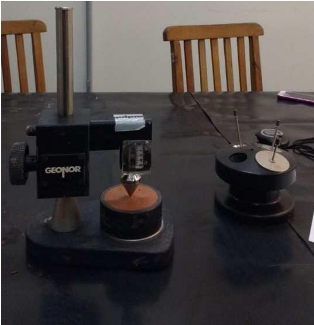
Fig. 2.3 - Aparelho Fall Cone utilizado no Laboratório de Ensaios de Campo de Instrumentação Prof. Márcio Miranda Soares da COPPE/ UFRJ. Fonte: Autoria Própria.
