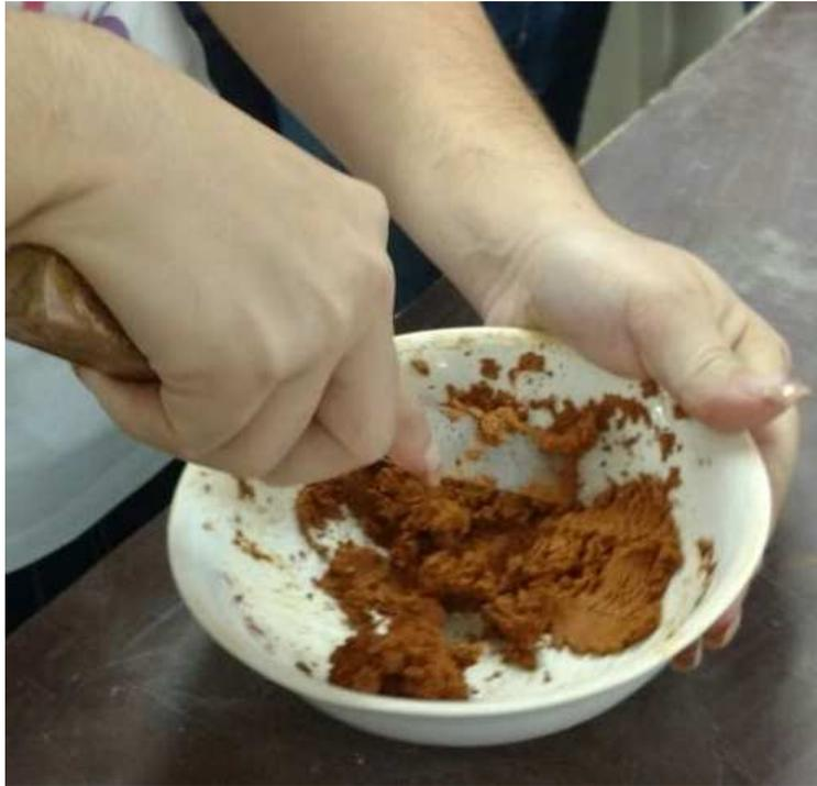
Fig. 4.4 - Processo de Homogeneização da amostra – Fonte: Autoria Própria.
