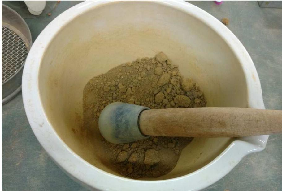
Fig. 4.1 - Preparo da amostra realizando o destorroamento do grão – Fonte: Autoria Própria
