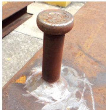
Figura 4.3 – Conector de pino com cabeça, (FAKURY, 2016).
