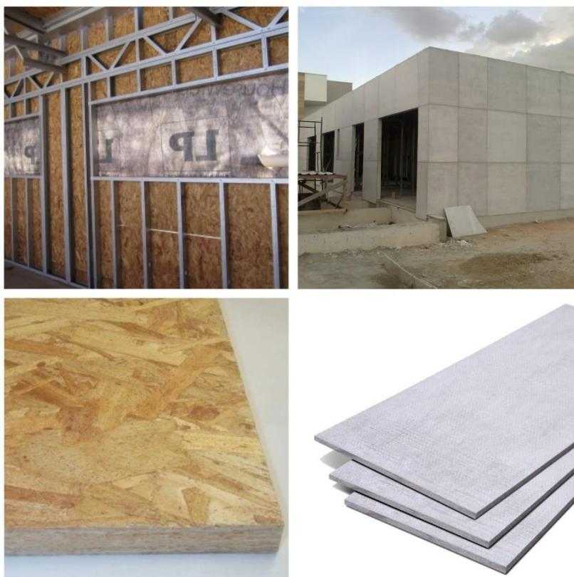
Figura 2.12 – Placas OSB e placas cimentícias, (SALLES, 2016).
