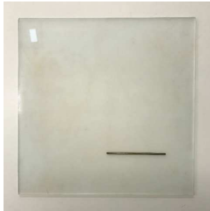
Figura 15: Placa de vidro esmerilhado e gabarito metálico
