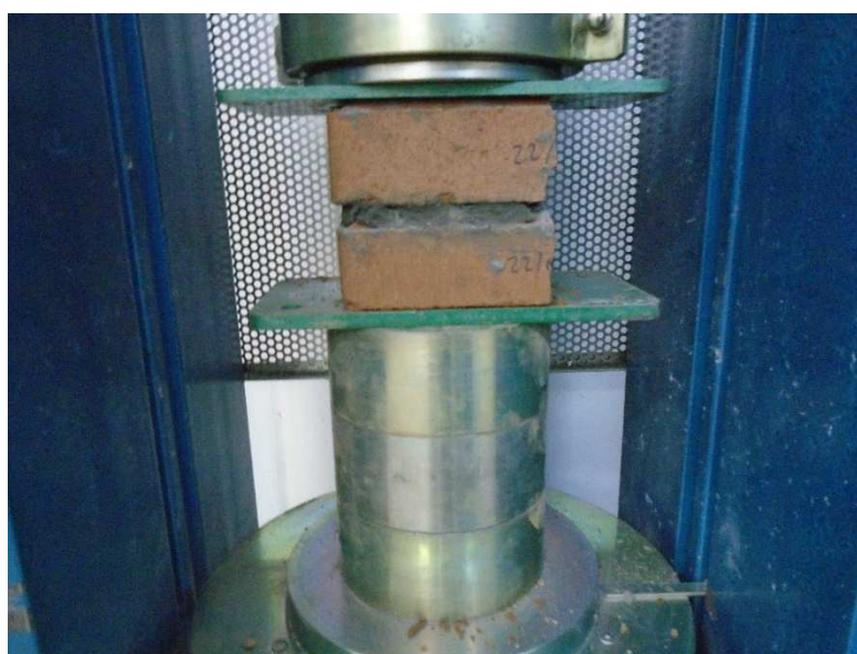
Figura 27: Ensaio com corpo de prova composto por duas metades de tijolo justapostas e coladas com pasta de cimento.
