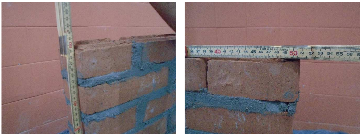
Figura 34: Verificação dimensional dos painéis.
