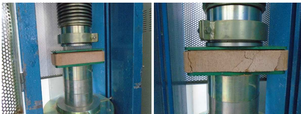
Figura 26: Ensaio com corpo de prova de tijolo único
