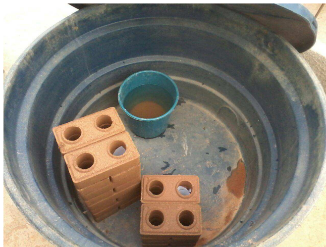
Figura 25: Cura dos tijolos na caixa d'água.
