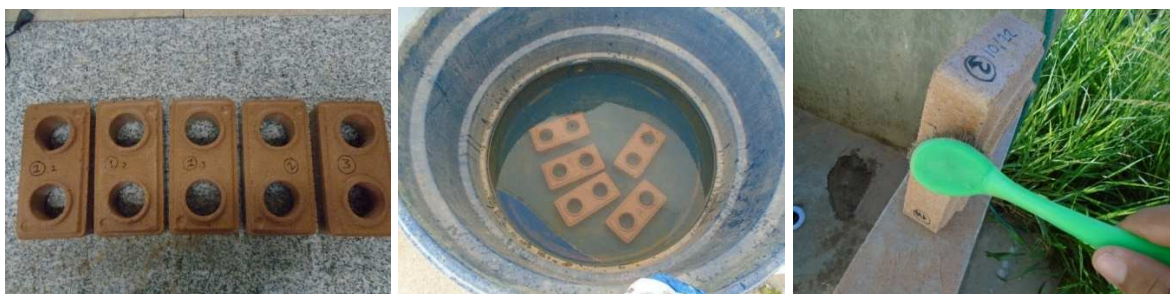
Figura 29: Numeração, imersão e escovação dos tijolos ensaio de durabilidade
