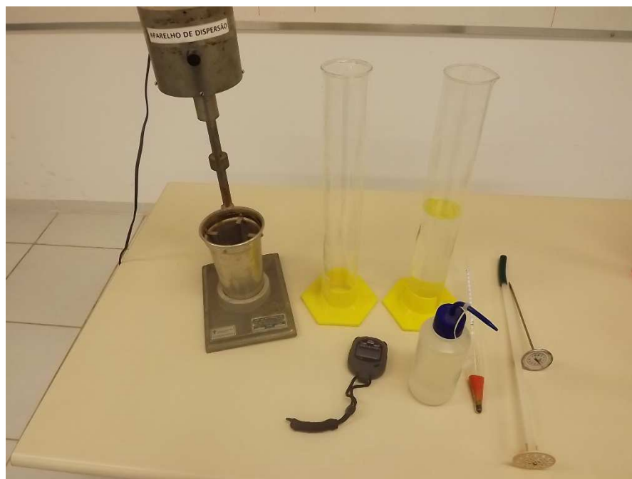
Figura 11: Aparelhagem utilizada no ensaio de sedimentação
