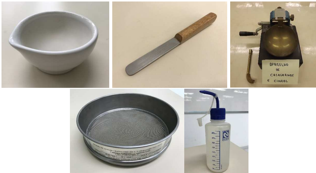
Figura 13: os equipamentos utilizados para a realização do limite de liquidez.
