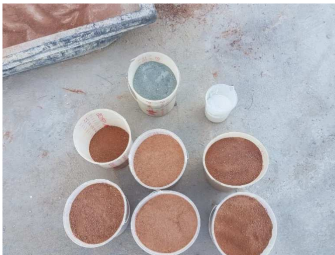
Figura 22: Cimento, cal e solo utilizados na mistura. Na ocasião, 9,2, 1,2 e 54 litros, respectivamente.
