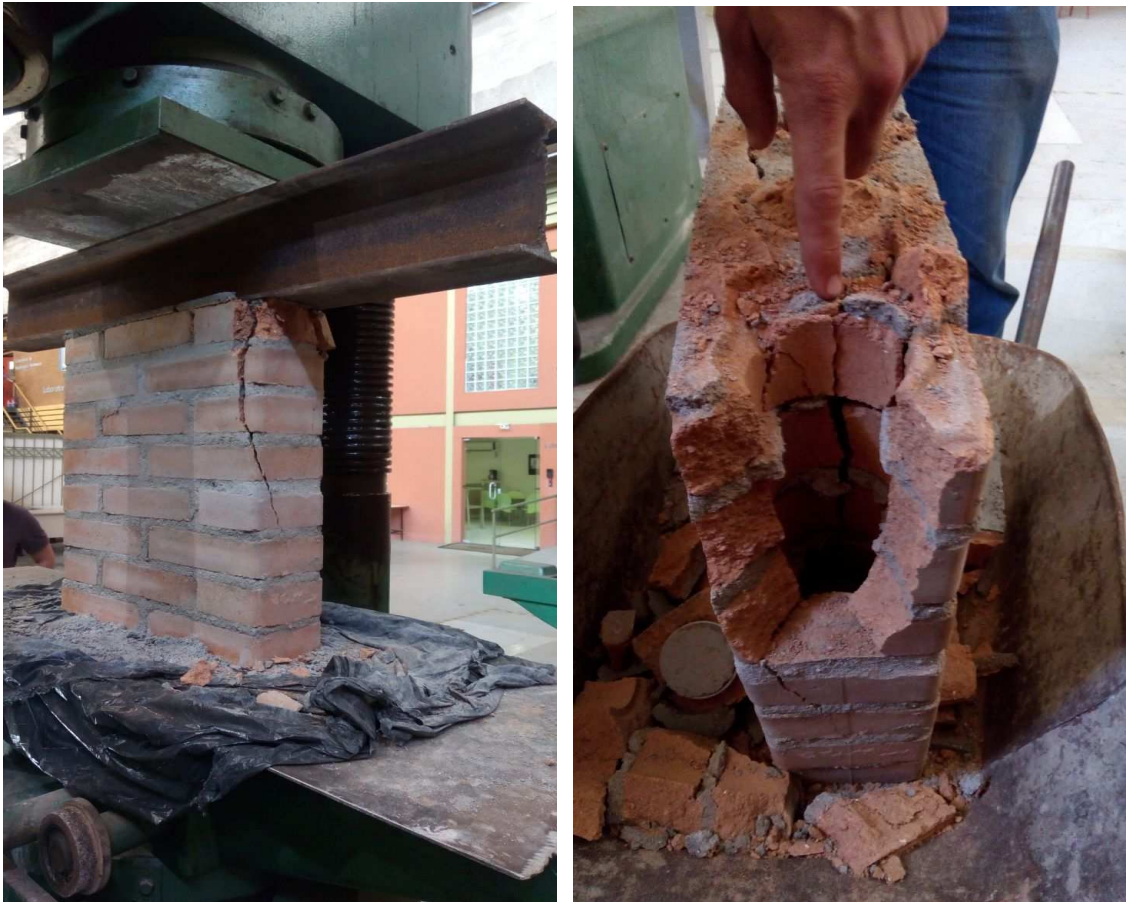
Figura 37: Ruptura do painel.
