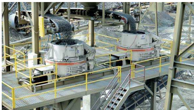
Figura 4: Britadores de eixo vertical tipo Barmac. Fonte: METSO (2018)
