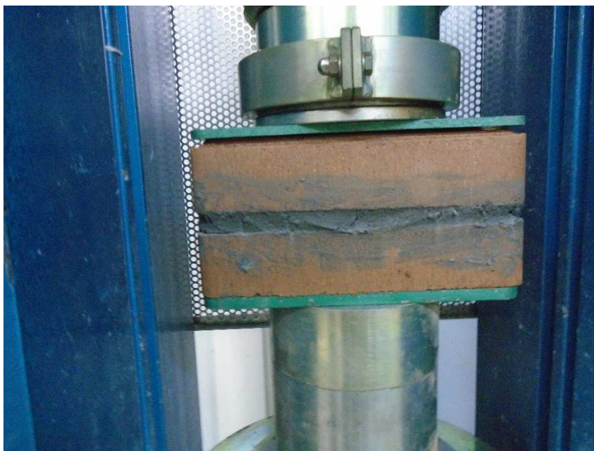
Figura 28: Ensaio com corpo de prova composto por dois tijolos justapostos e colados com pasta de cimento.
