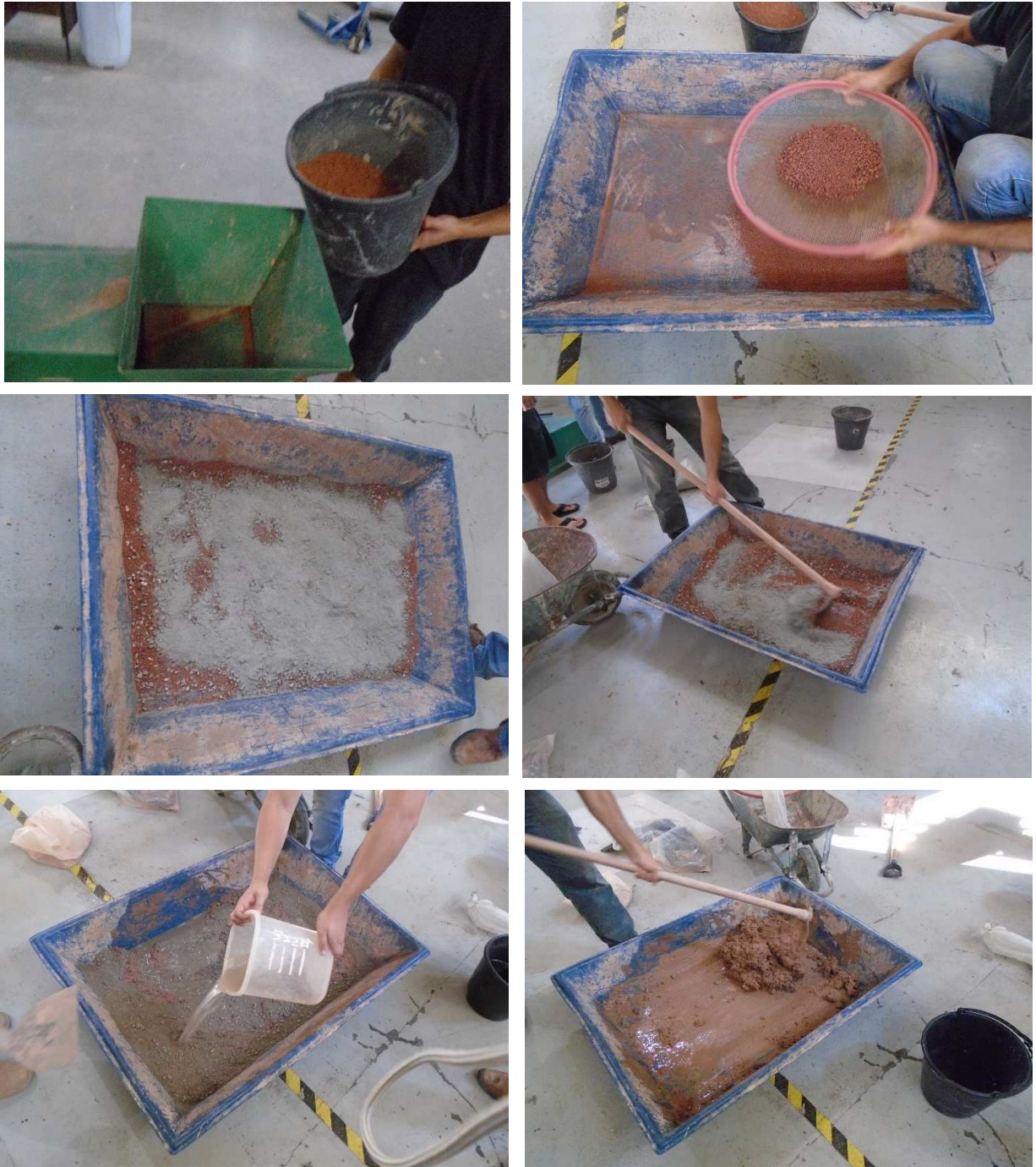
Figura 32: Processo de fabricação do graute. Destorroamento do solo; Peneiramento; Solo, brita e cimento em masseira; Mistura dos componentes; Adição de água na mistura; Graute com consistência adequada.
