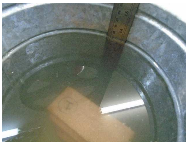
Figura 30: Determinação do volume dos tijolos
