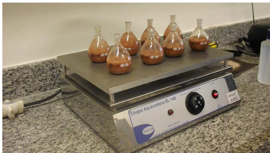
Figura 18: Determinação da densidade real dos grãos: Execução do ensaio
