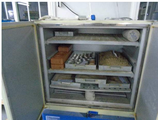
Figura 31: Estufa com corpos de prova
