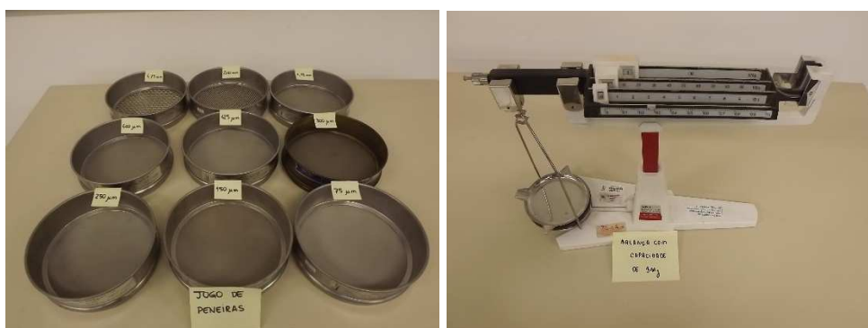
Figura 10: Jogo de peneiras e balança utilizadas no ensaio de peneiramento
