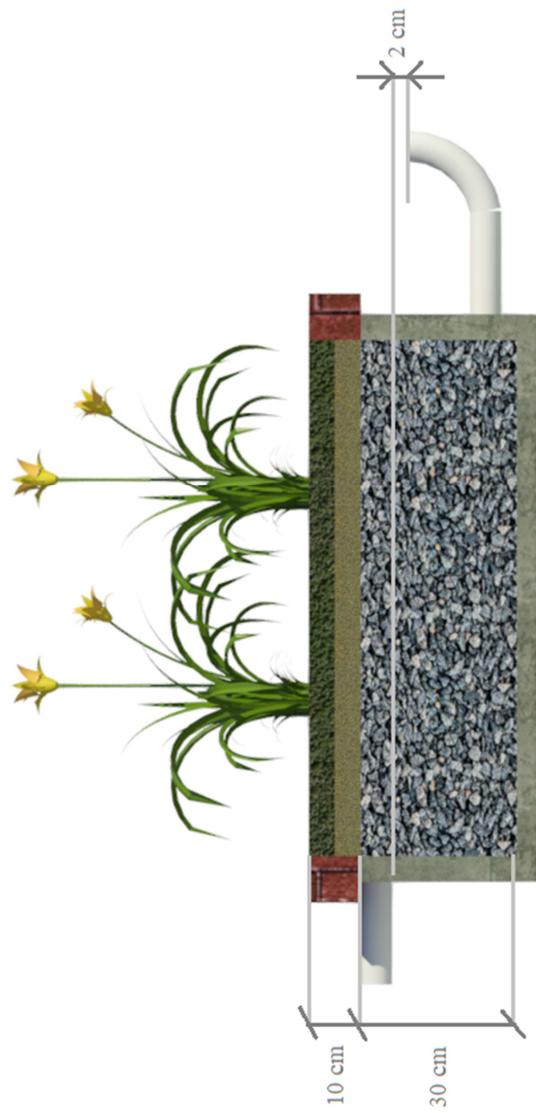
Figura 49: Corte esquemático com medidas de camadas e locação de canos (elaborado pela autora).
