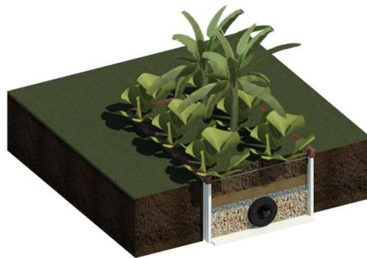
Figura 35: Corte das camadas do sistema Tanque de evapotranspiração (Autora).
