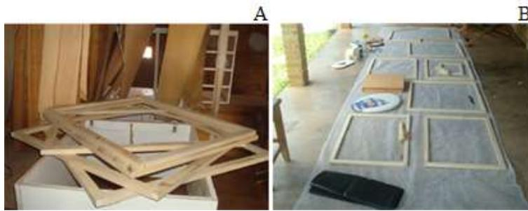
Figura 15: Gabaritos montados (A); Corte da tela mosqueteira (B) (ALENCAR, 2009).
