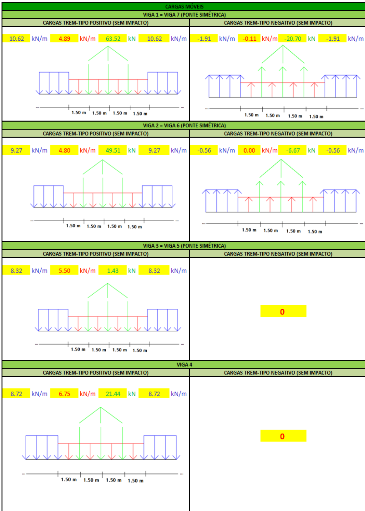
Figura 94 - Resultado: Trens-tipo positivo e negativo (cargas-móveis) para as vigas V1, V2, V3, V4, V5, V6 e V7.
