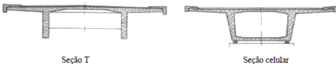
Figura 5 - Esquemas estruturais de pontes de viga.
