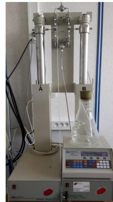
Figura 27 - Bomba utilizada para realização da drenagem
