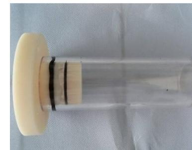
Figura 21 - Exemplo de célula com apenas um tampão, os anéis de borracha e o filtro
