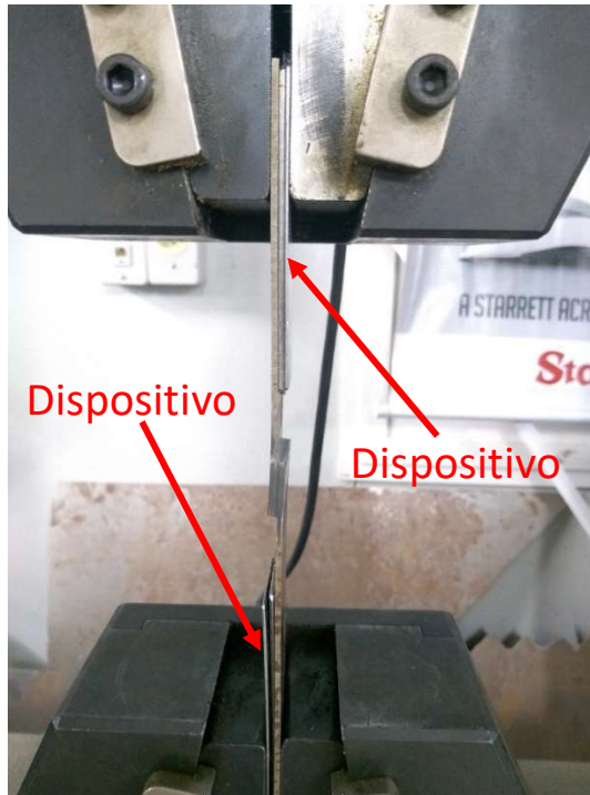
Figura 20: configuração utilizada para o teste de tração dos corpos de prova. Fonte: própria (2019).
