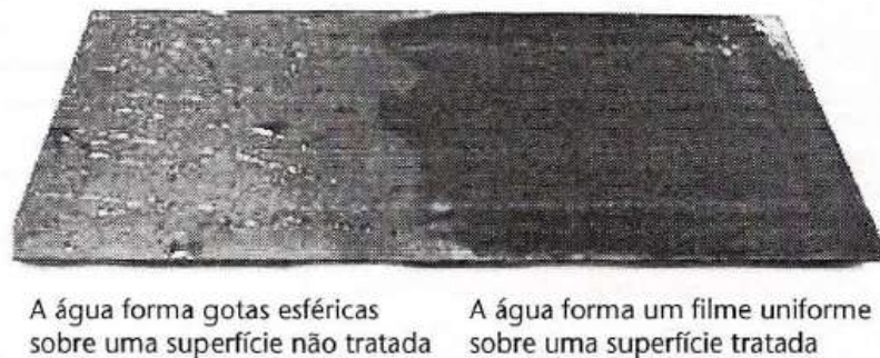
Figura 11: exemplo de diferentes comportamentos da água em uma superfície sem tratamento e em uma superfície tratada. Fonte: da Silva; de Magalhães; de Moura (2007)
