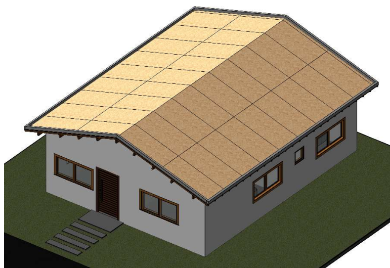
Figura 21: Fechamento lateral com placa cimentícia. Fonte: Autor (2019).
