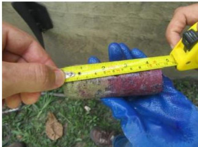
Figura 18: Medição da profundidade carbonatada.
