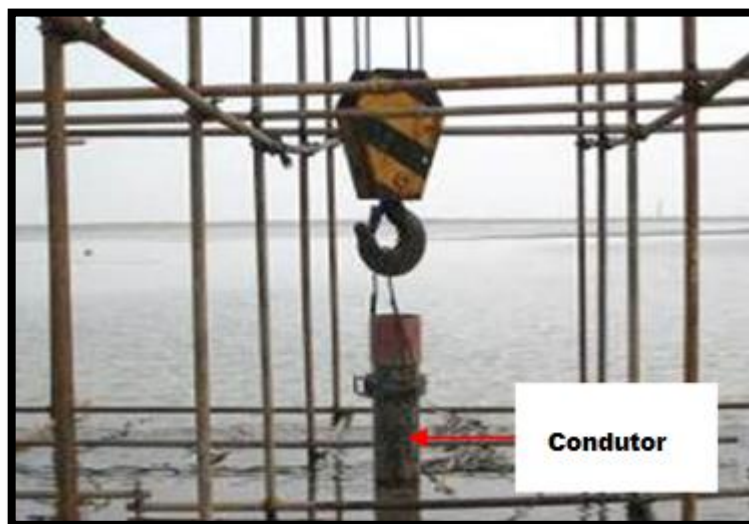
Figura 32 - Guincho executando o teste do puxão em campo experimental. Fonte: Adaptado de Zhou et al. (2016).
