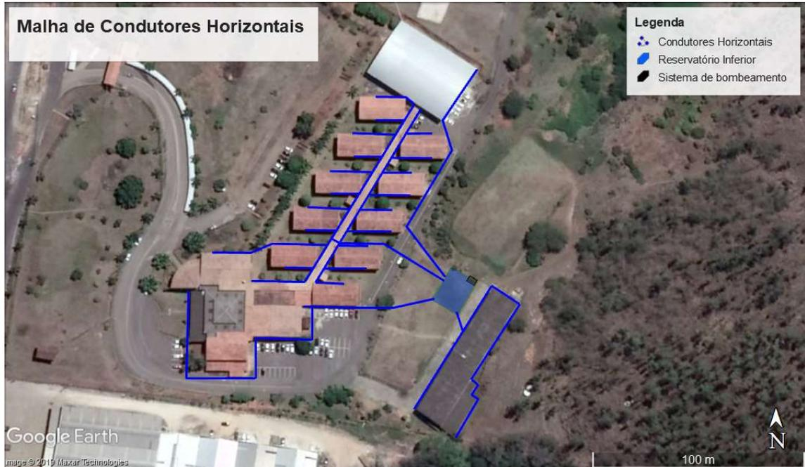
Figura 22: Malha de condutores horizontais.
