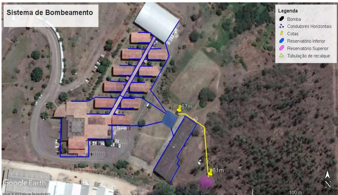
Figura 24: Ponto de instalação do reservatório superior e cotas altimétricas.
