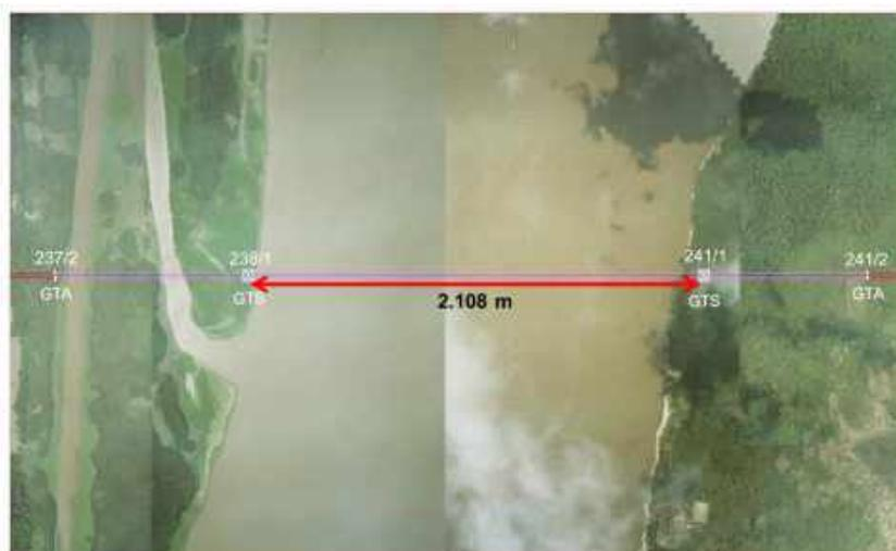
Figura 5.3 – Detalhe do Vão da Traversia, com mais de 2 km (IBAMA, 2011).
