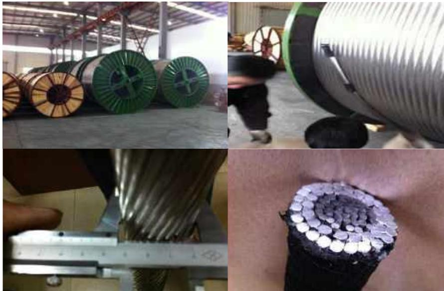
Figura 5.8 - Cabo AACSR/UGS 540 utilizado (HANGZHOU CABLE Co., LTD, 2012)
