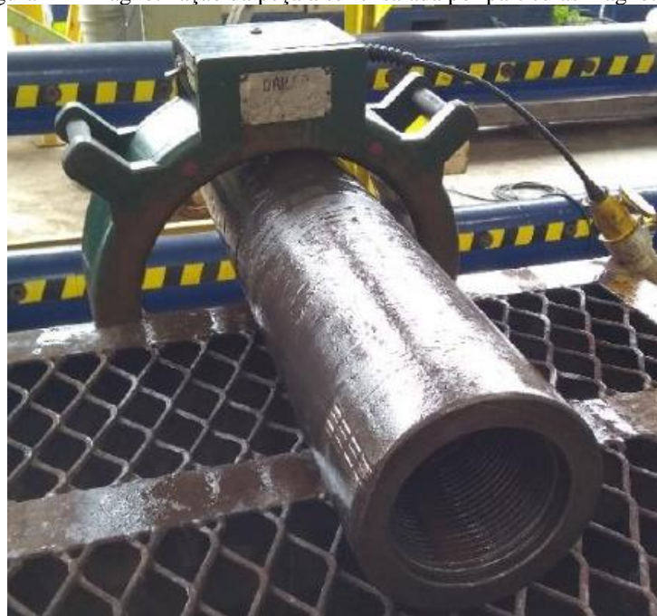
Figura 11 - Magnetização da peça a ser ensaiada por partículas magnéticas.
