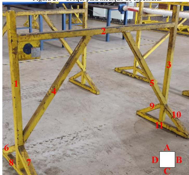
Figura 27 - Croqui para medição de espessura.
