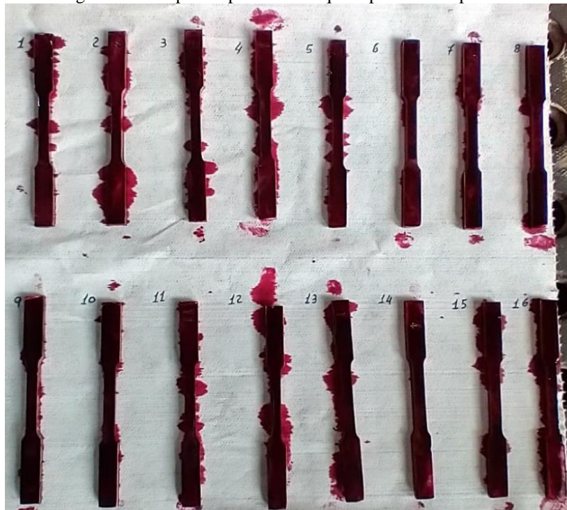
Figura 19 - Corpos de prova com líquido penetrante aplicado.
