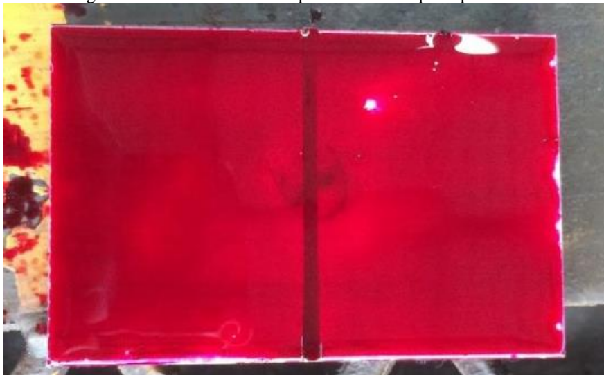
Figura 20 - Teste com o bloco padrão com o líquido penetrante.
