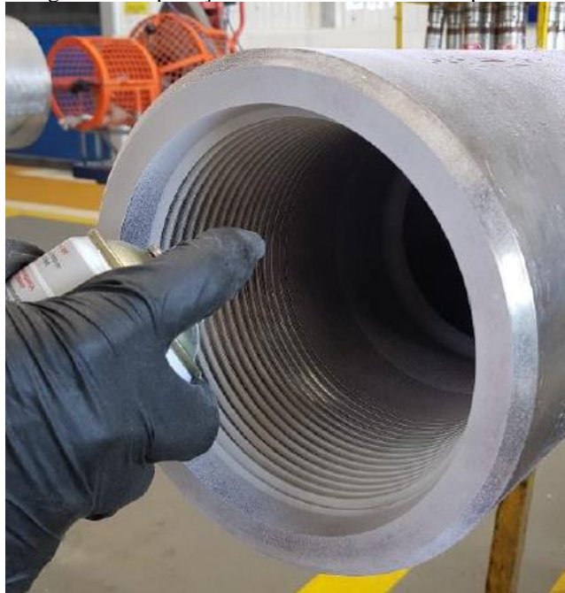
Figura 14 - Aplicação do filme revelador na superfície.
