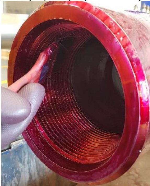
Figura 13 - Aplicação do líquido penetrante numa superfície.
