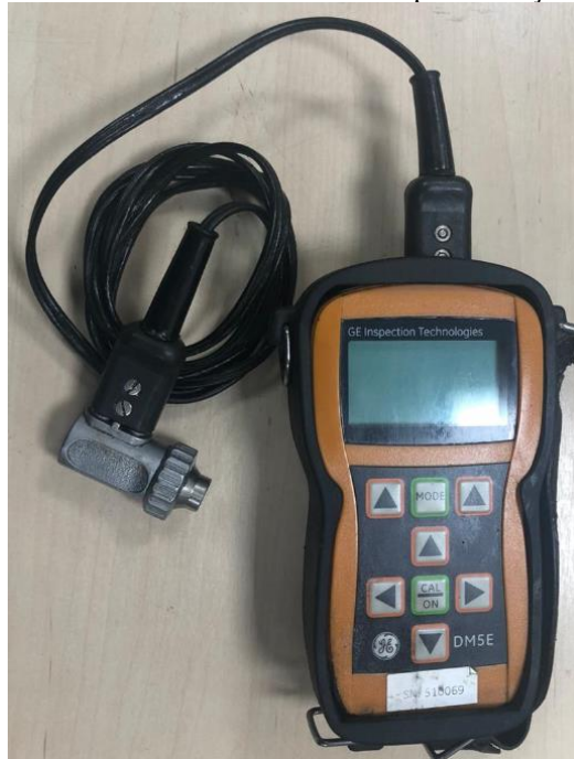
Figura 28 - Instrumento de ultrassom utilizado para medição de espessura.
