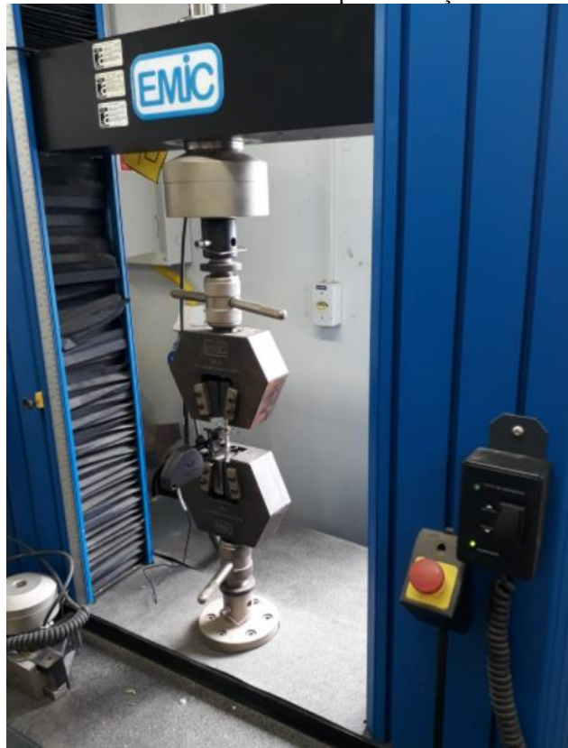
Figura 22 - Máquina universal de ensaios mecânicos para execução de ensaio uniaxial de tração.
