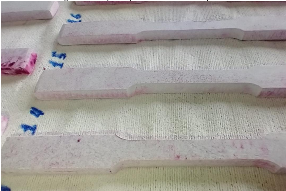
Figura 21 - Corpos de prova com o revelador aplicado.
