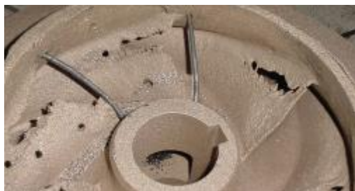
Figura 13: Rotor de bomba danificado por cavitação
