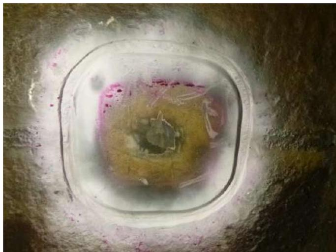
**Figura 17 - Ensaio por líquido penetrante. (Autor).**
