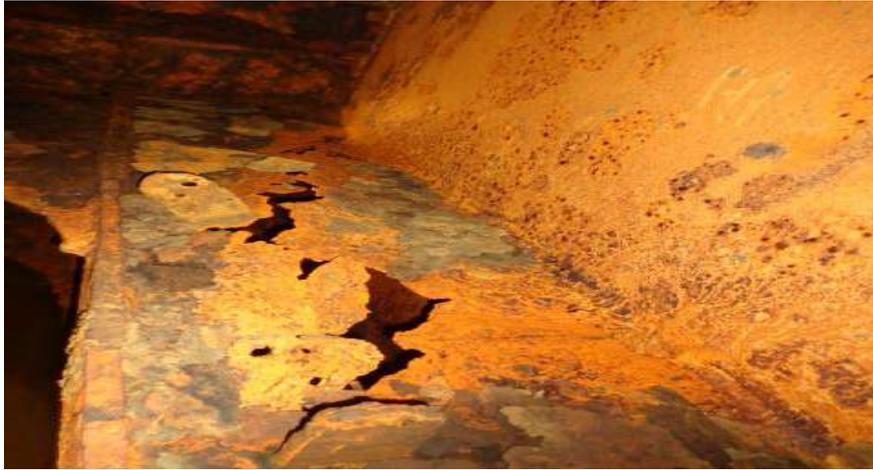
**Figura 4 - Exemplo de corrosão em chapa de aço naval. (Autor).**
