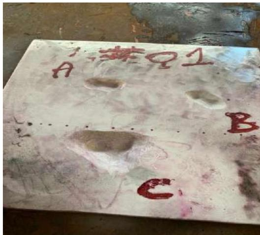
**Figura 28 - Corpo de prova 1 (depressões irregulares). (Autor).**
