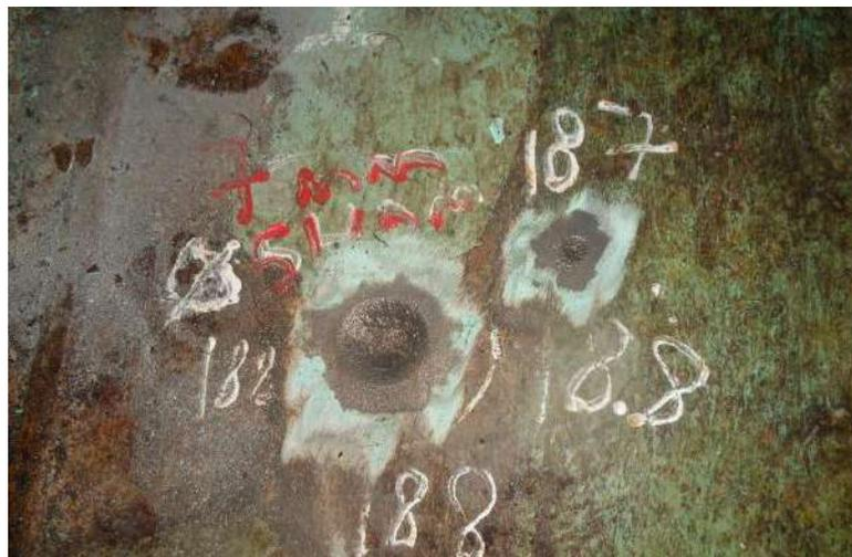
Figura 7 - Corrosão por pite em chapa AH 36 no fundo de um FPSO. (Autor).
