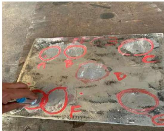
**Figura 36 - Ultrassom em peça finalizada - Peça #03. (Autor).**
