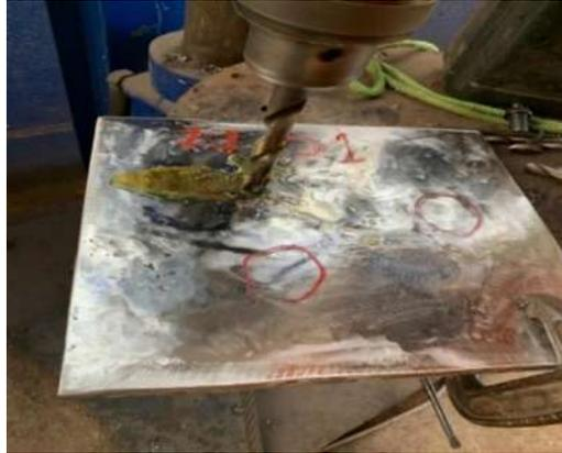
**Figura 27 - Broca penetrando corpo de prova (simulação de pite). (Autor).**
