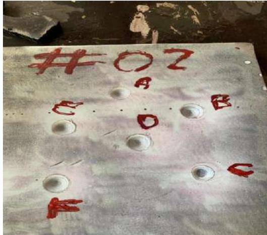
Figura 29 - Corpo de prova 2 (depressões regulares). (Autor).
