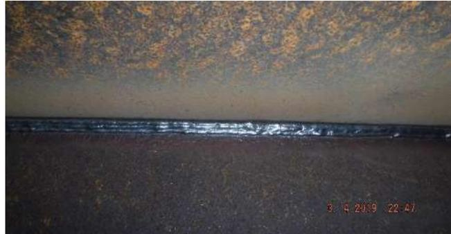
**Figura 16 - Cordão de solda pronto para inspeção visual. (Autor).**
