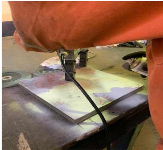
**Figura 35 - Ensaio por PM em peça finalizada - Peça #02. (Autor).**
