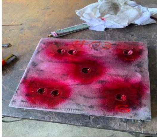
**Figura 34 - Ensaio de LP em peça finalizada - Peça #03. (Autor).**
