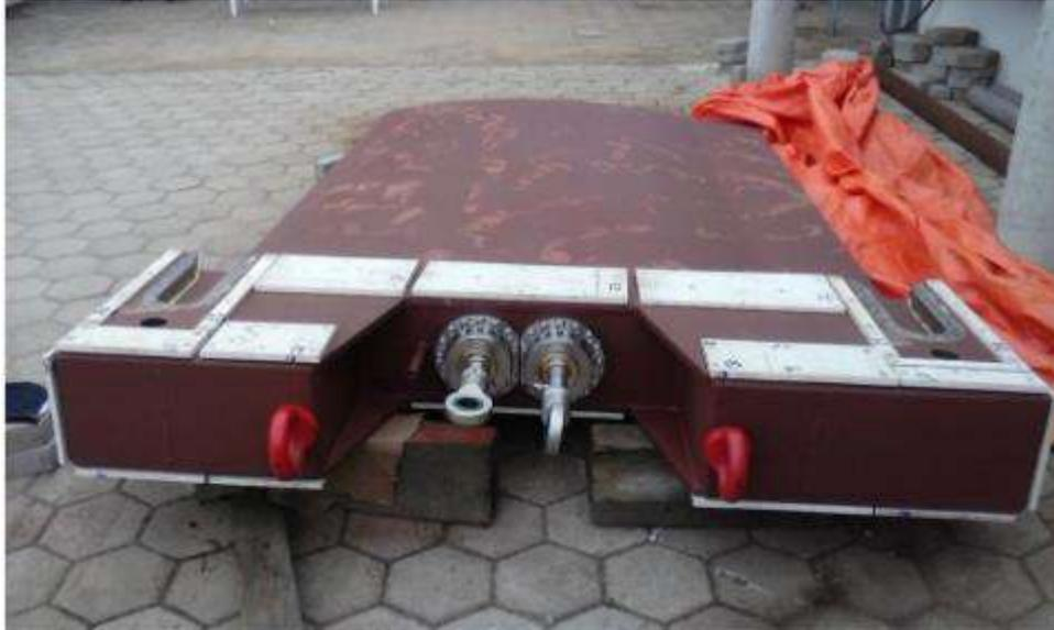
**Figura 48 - Quilha após fabricação. (CONCEIÇÃO, 2016)**
