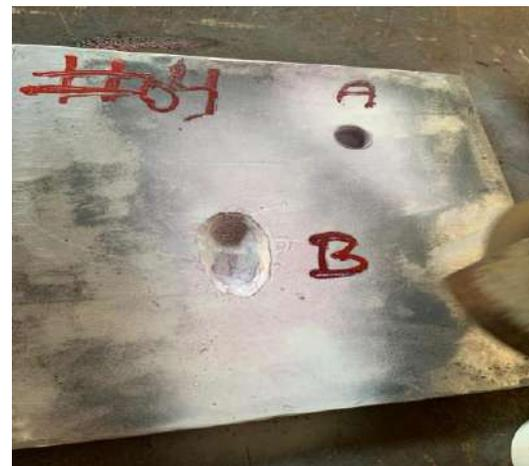
Figura 31 - Corpo de prova 4 (depressão irregular e regular). (Autor).
